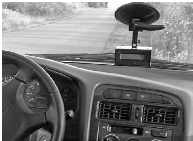
2 pav. Prietaiso „XL Meter Pro“ pritvirtinimas automobilyje bandymų metu
