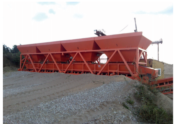
2 pav. Geležinkelio pobalastinio užpildų mišinio gamybos įrenginys su skirtingų medžiagų priėmimo ir dozavimo bunkeriais
